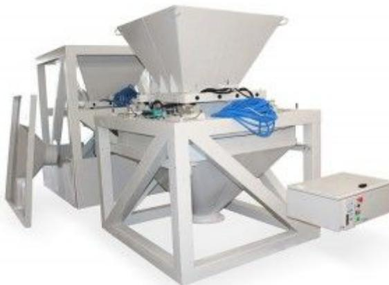
Контролер А-100 вынесен в отапливаемое помещение, длина кабеля 30 м. Рама весов закрыта панелями из листового металла с отбортовками. Две противоположные боковые панели имеют патрубки диаметром 200 мм длиной 200 мм для подключения к системе аспирации. Верх весов закрывается кожухом в виде пирамиды с приемным патрубком с фланцем с внутренним диаметром 300 мм.
