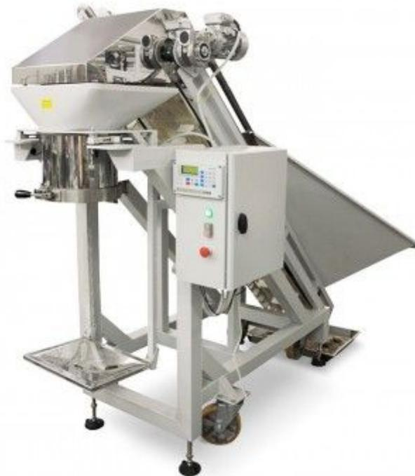
Дозатор предназначен для дозирования крупнокусковых продуктов, таких как картофель, лук, свекла, морковь дозами от 5 до 50 кг в сетки, пакеты бумажные, полипропиленовые и полиэтиленовые мешки.
