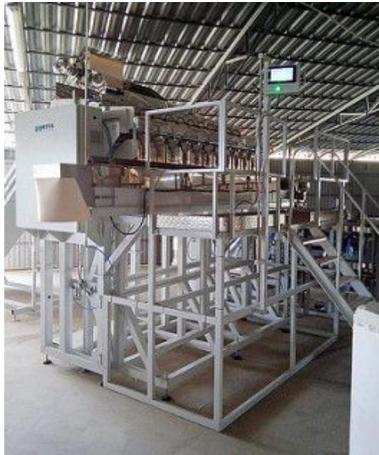
ДВКЛ-НОТИС-12-1-Тр дозатор весовой комбинационный предназначен для весового дозирования крупнокусковых продуктов, таких как морковь, картофель, свекла и др. дозами до 20 кг. Выборка производится из 12 ковшей, доза набирается из 6–9 ковшей, что обеспечивает высокую скорость и точность дозирования.
