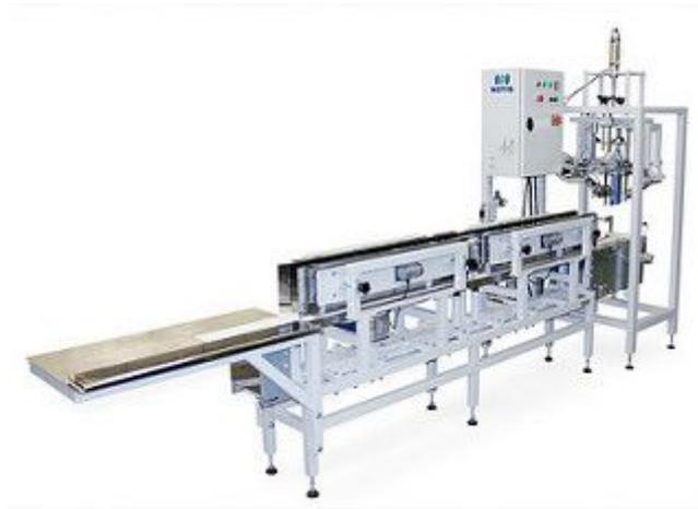
Устройство предназначено для уплотнения продукта в бумажном пакете и формирования верха пакета, заполненного порошкообразным продуктом перед переходом пакета на конвейер МЗБП-НОТИС. Верх пакета формируется в виде плоского гребешка, при этом не только складываются правильно все складки пакета, но и выдавливается из пакета избыточный воздух.
