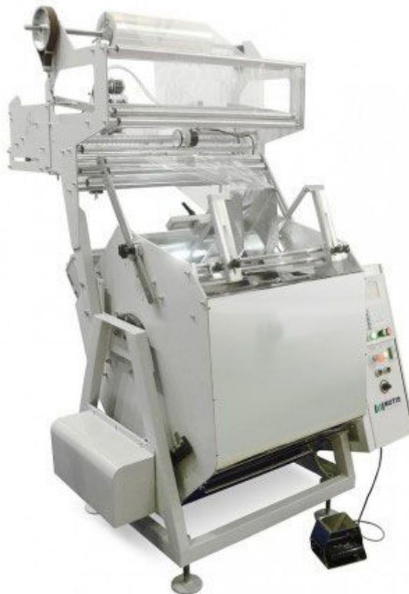
Машина предназначена для упаковки в термосвариваемые пленки штучных изделий с относительно большими размерами (хлебобулочные изделия, кондитерские изделия, пищевые продукты на подложке, штучные непищевые изделия). В базовую комплектацию машины включены: датчик длины пакета и датчик наличия и длины продукта.
